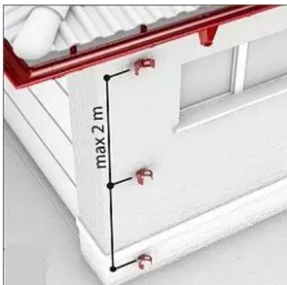
Установка держателей для сливной трубы
